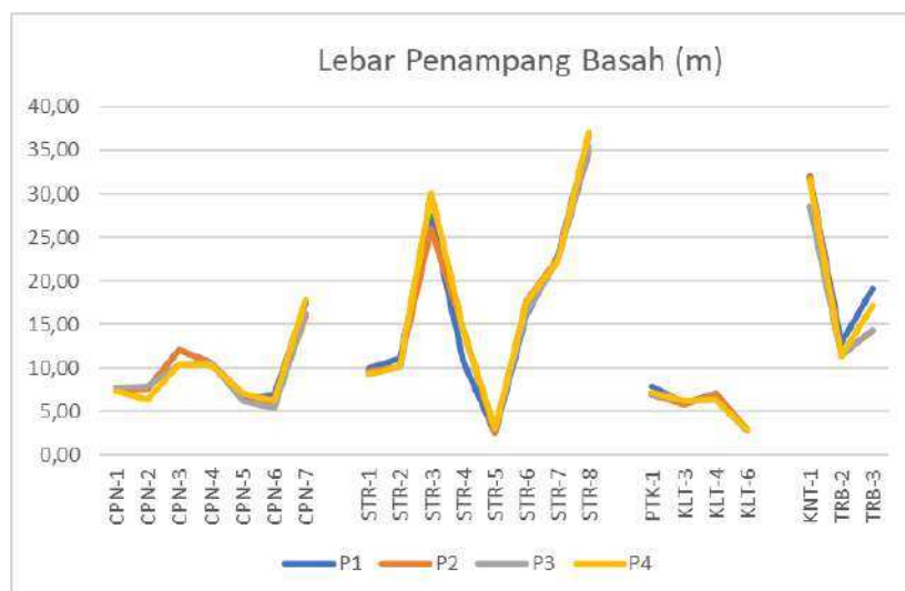
Gambar 3.96. Profil lebar penampang basah sungai di DAS Sunter.
