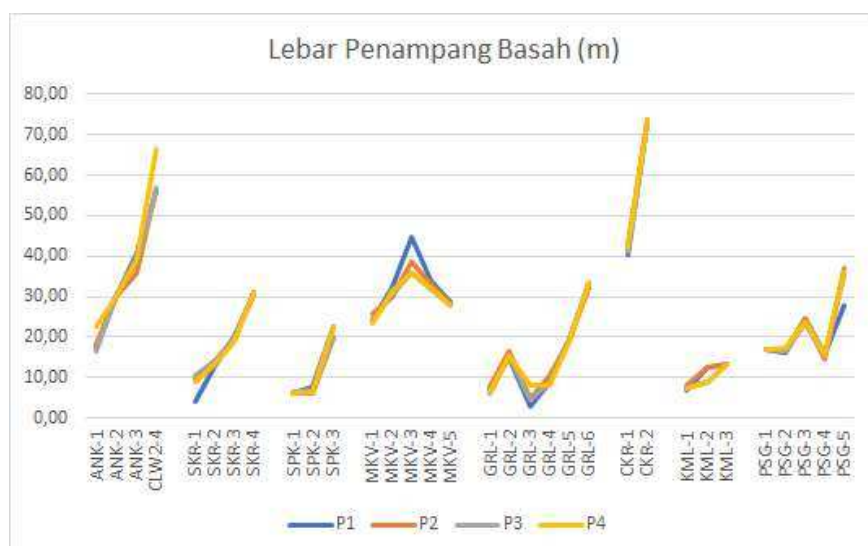
Gambar 3.53. Profil lebar penampang basah sungai di DAS Angke Pesanggrahan.
